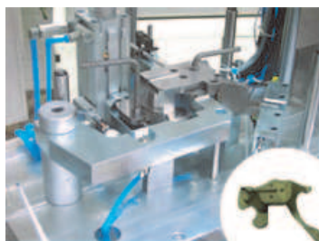
Vermessung von Schmiedewerkstücken
